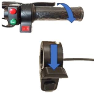
Durch Drehen des Griffs oder Ziehen des Abzugs entsprechend dem blauen Pfeil beschleunigt die Maschine schnell.
